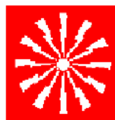
PULSANTE DI ALLARME ANTINCENDIO
