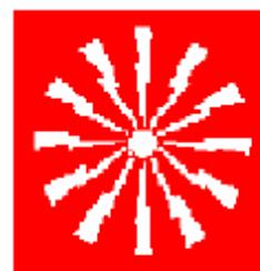
PULSANTE DI ALLARME ANTINCENDIO
