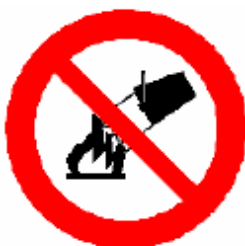
VIETATO SPEGNERE CON ACQUA
