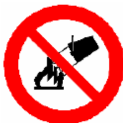
VIETATO SPEGNERE CON ACQUA
