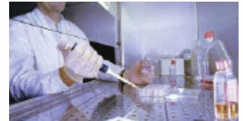
Non usare bunsen o altri tipi di bruciatori sotto le cappe di tipo II e III, l'aria calda indotta può deviare il regolare flusso interno dell'aria, e causare contaminazione dell'area di lavoro, dell'ambiente esterno e danni ai filtri HEPA.
