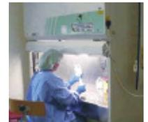
Evitare il passaggio di persone alle spalle dell'operatore, l'apertura o la chiusura di porte nella stanza per non alterare il flusso laminare.
