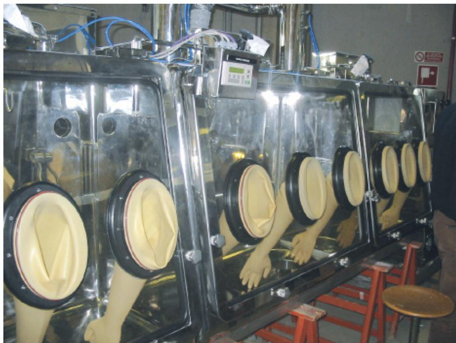
Figura. 38 - Foto di isolatore a doppia camera
