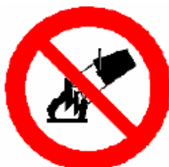
VIETATO SPEGNERE CON ACQUA
